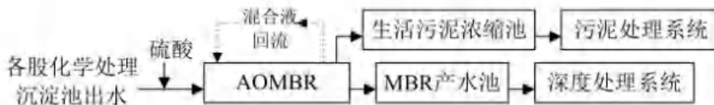
图 8.1-10 生化处理工艺流程图
